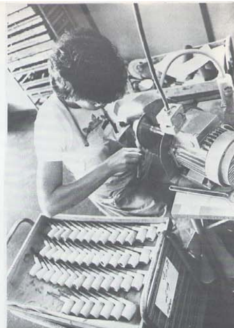
Mitarbeiterin an der Schleifscheibe
